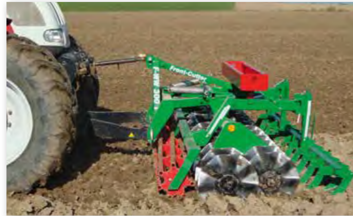
Front-Cutter WW „T“ mit Rohrstabwalze und Messervorsatz
