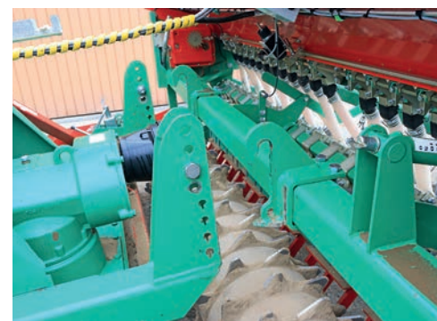
Mit dem Schnellkuppelsystem ohne Oberlenker ist die Seedstar schnell von der Kreiselegge abgebaut.
