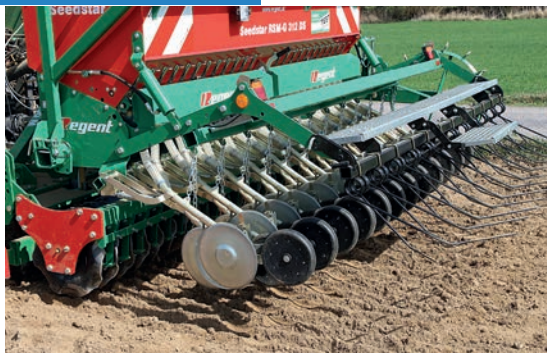
Scharenheit und Striegel lassen sich hydraulisch ausheben.
