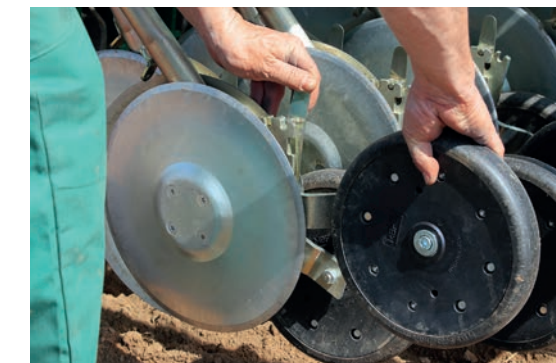
Die Doppelscheibenscharre samt Andruckrollen gefielen uns im Test sehr gut.
